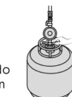
**2.** Encaixe o anel de vedação dentro das extremidades e fixe o tubo flexível metálico no regulador de pressão com registro de rosca externa  $\frac{1}{2}$ ", usando a chave ajustável.
