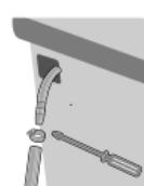
**3.** Conecte o regulador de gás ao botijão. Aperte com as mãos. O sistema foi desenvolvido para vedação com a força "manual".
