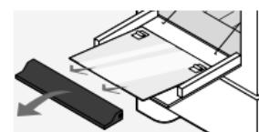
**Remoção das prateleiras:** a remoção é necessária para facilitar a limpeza da cavidade do forno. Para reinstalar, siga o caminho inverso.
