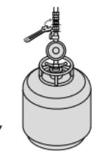
**4.** Ligue o gás e verifique se há vazamentos usando detergente líquido viscoso.
