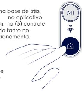
**IMPORTANTE:** caso o aspirador robô não ligue devido à falta de bateria, mova-o manualmente até a base de carregamento. Alinhe os contatos de carregamento e garanta que a escova para cantos não fique presa entre eles. Lembramos que o produto só começa a carregar quando as luzes brancas pulsarem. Caso isso não aconteça, seu produto não está carregando.
