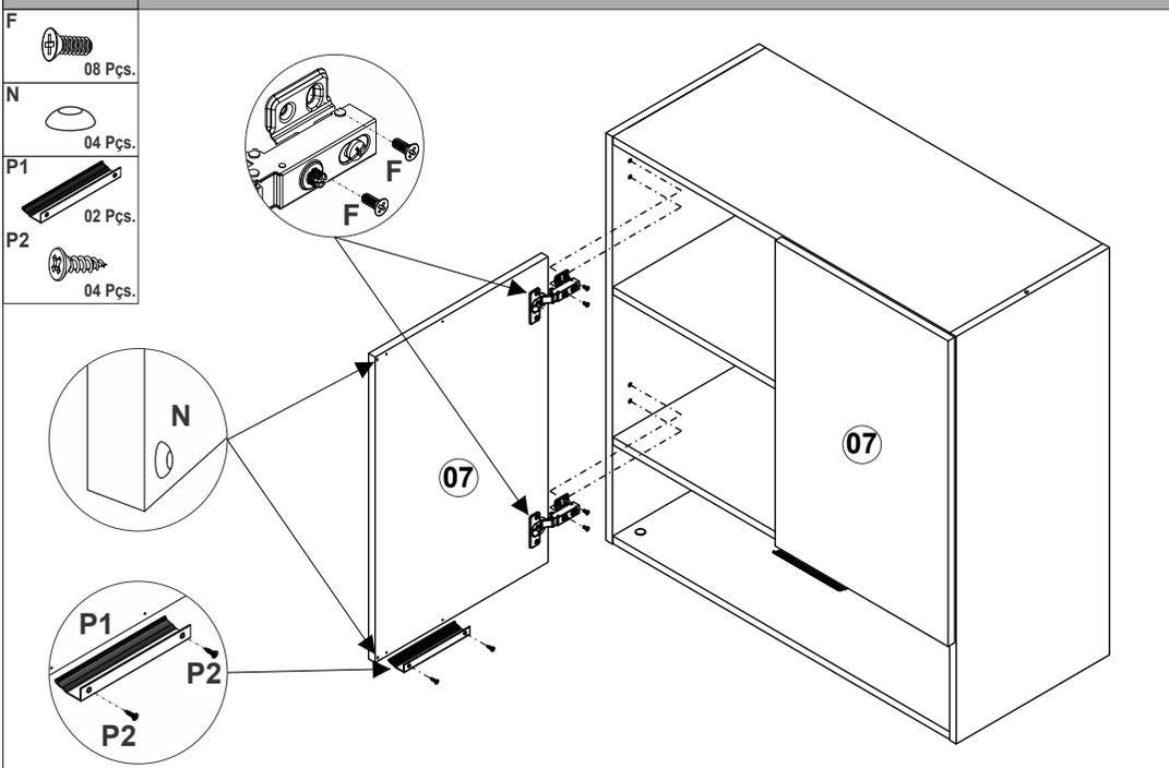
**Passo - 07 MONTAGEM** Efetuar a regulagem na porta conforme a ilustração abaixo.
