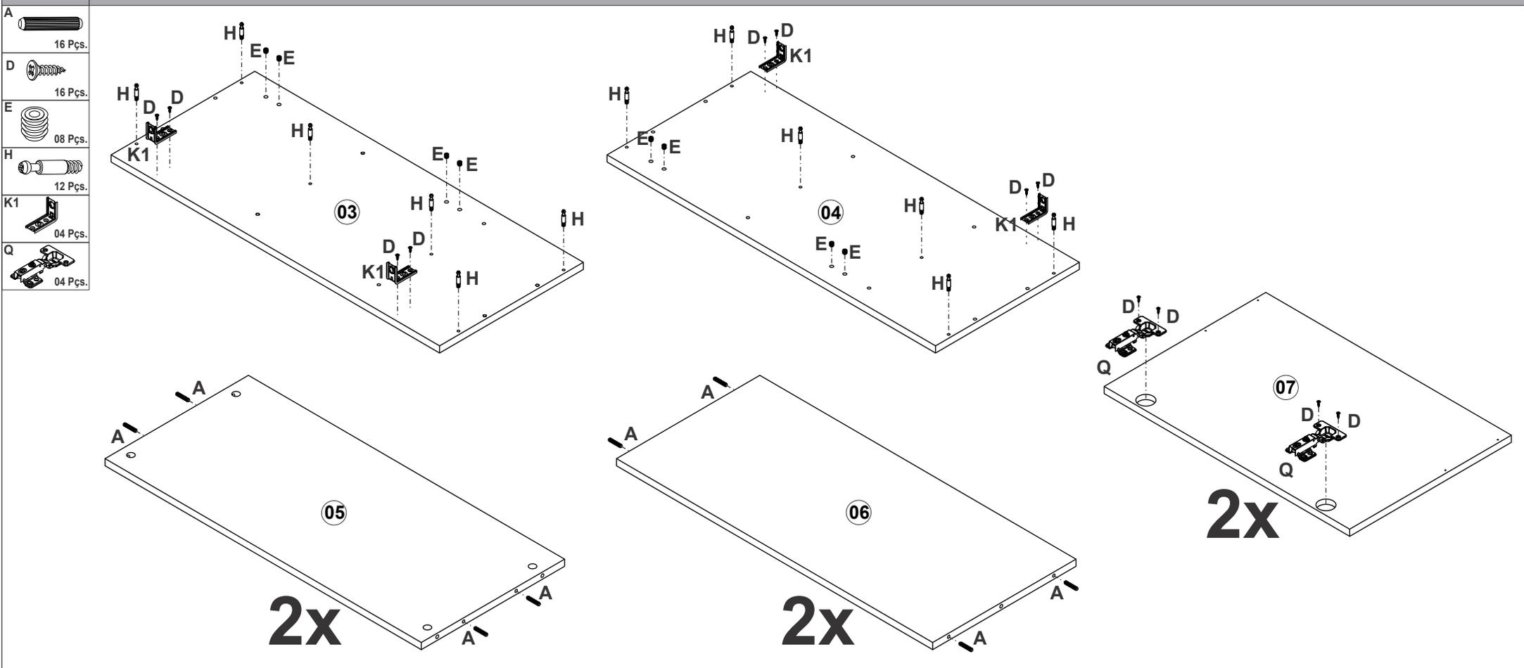
**Passo - 02 MONTAGEM** Montar o armário conforme a ilustração abaixo, unir as peças 05 e 06 na peça 03, utilizando a ferragem G e O.
