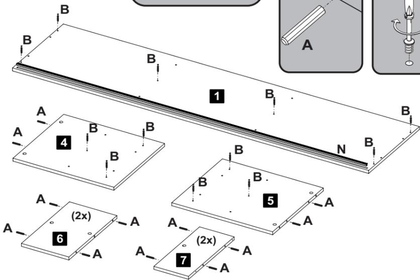
A Caviha 20 B Minifix Ø7x30mm 12 N Perfil 1684mm 01
