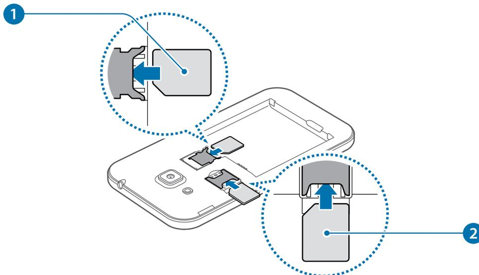
**▶ Modelos Single chip:** insira o chip micro no telefone com os contatos dourados voltados para baixo.
