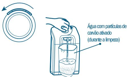
Abra a válvula de acionamento de água girando o botão no sentido anti-horário, e com o auxílio de um recipiente, deixe escoar 20 litros de água pelo filtro até que sejam eliminadas as partículas de carvão ativado em suspensão.
