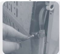
Aperte a abraçadeira com chave de fenda
