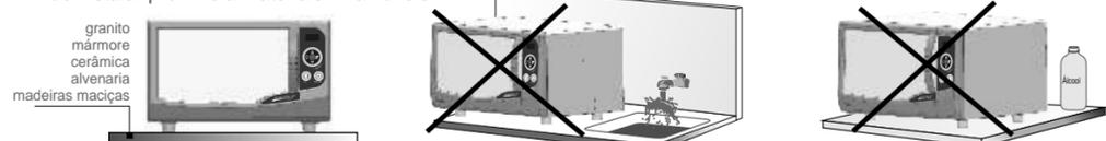
Caso o forno seja colocado em suporte de parede, certificar-se de que o mesmo pode suportar o peso do forno. Caso queira colocá-lo no móvel, respeitar as distâncias conforme indicado abaixo.
