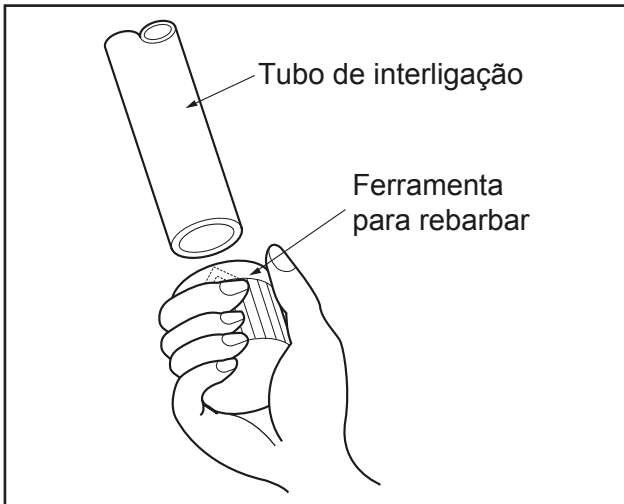
FIGURA 27 - FERRAMENTA PARA REBARBAR
