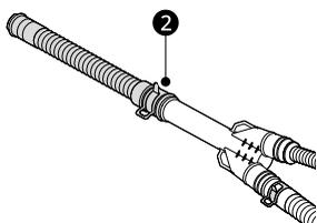
4 Conecte firmemente a mangueira de drenagem curta a uma torneira de drenagem, a um tubo vertical ou a um tubo de desvio da pia da lavanderia.
