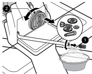
**4** Após limpar o filtro da bomba de drenagem, reinsira o filtro com cuidado e enrosque a tampa de drenagem no sentido horário com cuidado para evitar a falta de alinhamento das roscas e vazamentos. Reinsira o plugue novamente no tubo de drenagem e coloque o tubo em seu suporte.
