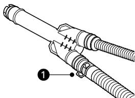
3 Use a abraçadeira (2) na mangueira de drenagem curta para fixá-la na abertura inferior do conector da mangueira de drenagem.
