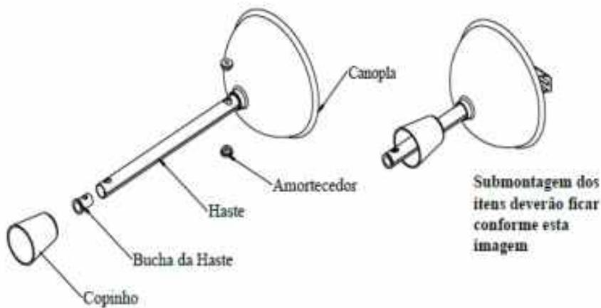
Na imagem mostra a posição que Haste deverá ser montada, com o suporte de fixação para o lado correto.
