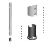
Encaixe a haste no eixo do motor, insira a cupilha e abra as pontas de forma que ela abrace a haste.
