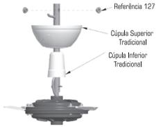
Insira a haste na cúpula inferior tradicional e a cúpula superior tradicional encontrando ambas aproximadamente no centro da haste, como mostrado na figura. Passe os cabos elétricos pelo orifício inferior da haste, saindo pelo orifício superior. Desça a cúpula inferior tradicional de modo que a mesma esconda a cupilha.
