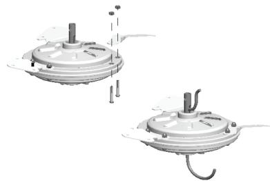
Coloque as garras sobre o motor com a inclinação voltada para cima e fixe-as utilizando os parafusos 4,8 (3/16") x 25,4mm (1") e juntamente com as porcas sextavadas 4,8mm (3/16") x 7,9mm (5/16").
