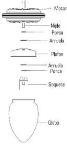
Insira o niple no motor e passe os cabos cinza em seu núcleo. Aperte-o com a porca sextavada 9,525mm x 4mm (3/8" x 5/32"). Coloque a arruela lisa 9,525mm (3/8"), em seguida insira o plafon no niple. Coloque outra arruela lisa e aperte com a porca 9,525mm x 4mm (3/8" x 5/32"). Certifique-se de que esteja bem apertado. Faça a ligação dos cabos cinza no soquete. Aparafuse o soquete tomando o cuidado para não torcer os fios. Coloque a lâmpada e fixe o globo utilizando as travas laterais do plafon.
