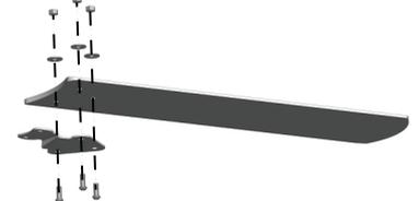
Posicione as pás sobre as garras e fixe-as utilizando os parafusos, arruelas e porcas.
