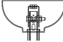
Encaixe a haste no suporte de fixação e fixe o ventilador utilizando o parafuso 6,35mm x 38,1mm (1/4" x 1 1/2") juntamente com a porca de 6,35mm x 11,11mm (1/4" x 7/16"). Manter a canopla superior afastada do teto aproximadamente 5mm.
