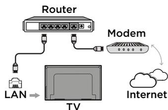
A conexão é realizada automaticamente quando o cabo de rede for conectado na entrada LAN do televisor.
