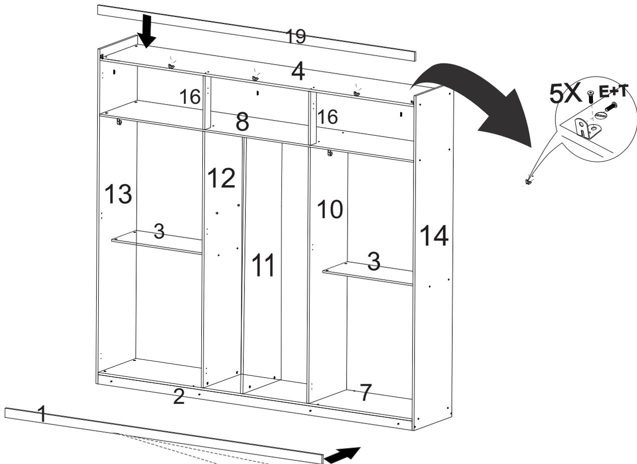
FIXAR VISTA NO RODAPÉ DE DENTRO PARA FORA COM PARAFUSOS 3,5X25MM ( J ), DEIXANDO 5 MM SOBRENDO PARA CADA LADO.
