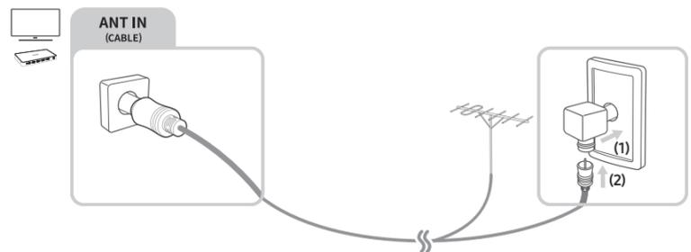
Conexão do adaptador de antena
