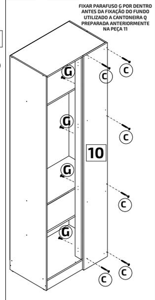
FIXAR PARAFUSO G POR DENTRO ANTES DA FIXAÇÃO DO FUNDO UTILIZANDO A CANTONEIRA Q PREPARADA ANTERIORMENTE NA PEÇA T1
