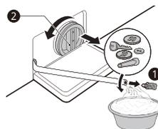
4 Depois de limpar o filtro da bomba de drenagem, retire-o e insira o plugue de drenagem.
