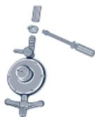
3. Conecte o regulador de gás ao botijão. Aperte com as mãos. O sistema foi desenvolvido para vedação com a força "manual".
