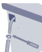
2. Coloque a outra abraçadeira na extremidade oposta da mangueira e encaixe no regulador de pressão. Aperte a abraçadeira com a chave de fenda.
