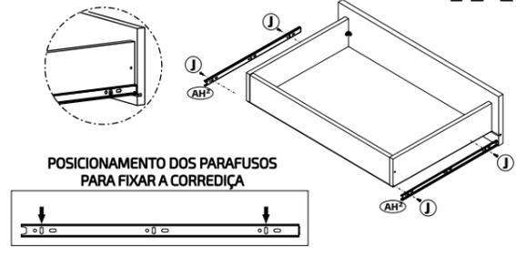
**POSICIONAMENTO DOS PARAFUSOS PARA FIXAR A CORREDIÇA**
