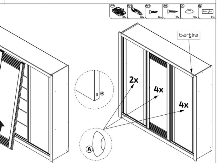
**ATENÇÃO USAR TORQUE DA PARAFUSADEIRA NO MÁXIMO "7"**
