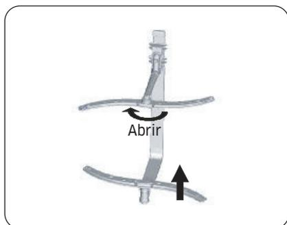
É necessário limpar os pulverizadores regularmente. Para remover o pulverizador intermediário, segure a porca e gire o pulverizador no sentido horário para removê-lo. Para remover o pulverizador inferior, puxe-o para cima. Lave os pulverizadores com água morna e sabão e, em seguida, use uma escova macia para limpar os orifícios. Enxágue bem os pulverizadores e coloque-os de volta no lugar.
