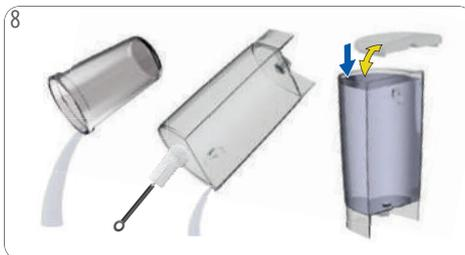
Esvazie e limpe o recipiente. Lave e limpe o reservatório de água. Utilize uma escova limpa e detergente se necessário. Encha o reservatório de água com água potável fresca e coloque-o na máquina. Coloque o recipiente debaixo do bico de saída da bebida.
