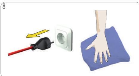
Desligue a máquina. Retire o plugue da tomada! Limpe a máquina com um pano macio úmido. Em seguida seque com um pano seco.
