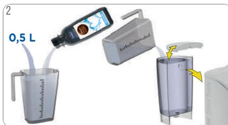
2 Se houver, retire a água do reservatório de água. Misture 0,5 litro de água potável fresca com o descalcificante num copo medidor. Coloque a solução descalcificante no reservatório de água e insira o reservatório de água na máquina.
