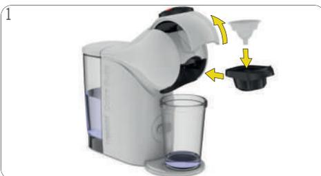
1 Coloque a ferramenta de enxágue no suporte para a cápsula. Insira o suporte de cápsulas na máquina.
