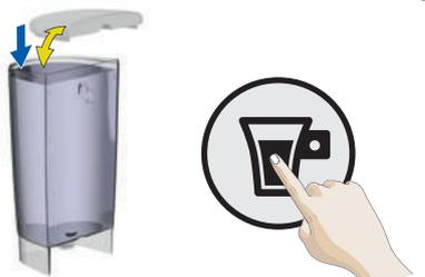
Verifique se há água potável fresca suficiente no reservatório. Em caso negativo, torne a encher com água potável fresca e aperte o botão liga/desliga para continuar com a preparação. Caso o líquido continue não saindo, verifique 10.3 “NÃO SAI LÍQUIDO – CÁPSULA BLOQUEADA?”.
