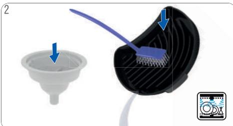
Lave o suporte de xícaras, suporte de gotejamento e a ferramenta de enxágue com água potável fresca. Limpe o suporte de xícaras e gotejamento com uma escova para alimentos limpa. Alternativamente, lave a suporte de copos na máquina de lavar louça.
