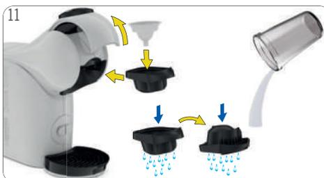
Remova o recipiente. Esvazie e limpe o recipiente. Retire o suporte de cápsulas. Remova a ferramenta de enxágue. Mantenha a ferramenta de enxágue em um local seguro para limpeza ou descalcificação posterior. Enxágue ambos os lados do suporte de cápsulas com água potável fresca. Reinsira o suporte de cápsulas e feche a alavanca.
