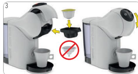
3 Assegure-se que a ferramenta de enxágue não esteja no interior. Insira a primeira cápsula no suporte de cápsulas. Recoloque-o na máquina. Feche a alavanca de fechamento.
