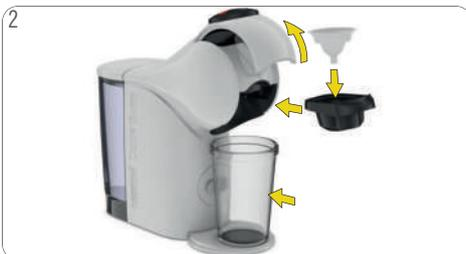
2 Abra a alavanca de fechamento. Coloque a ferramenta de enxágue no suporte para cápsula. Insira o suporte de cápsulas na máquina. Coloque um recipiente grande vazio embaixo da saída da bebida.
