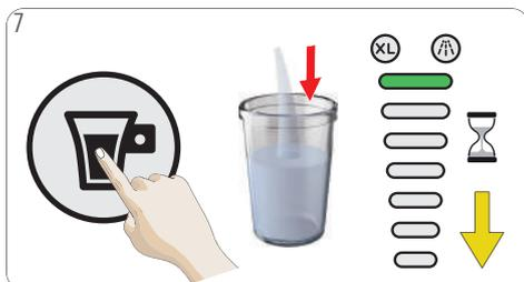
7 Aperte o botão liga/desliga. A máquina inicia a lavagem. Aguarde até que a máquina pare automaticamente. O botão de seleção da temperatura e a luz do display do volume piscam por até 8 segundos.
