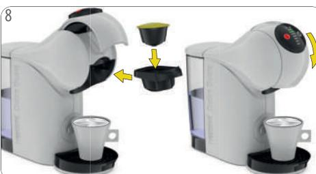
8 Insira a segunda cápsula no suporte de cápsulas. Recoloque-o na máquina. Feche a alavanca de fechamento.
