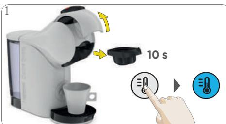
1 Abra a alavanca de fechamento. A máquina liga automaticamente. Pressione o botão de seleção da temperatura em até 10 segundos após ligar a máquina para mudar para o modo frio (azul). Bebida fria pode ser preparada imediatamente.
