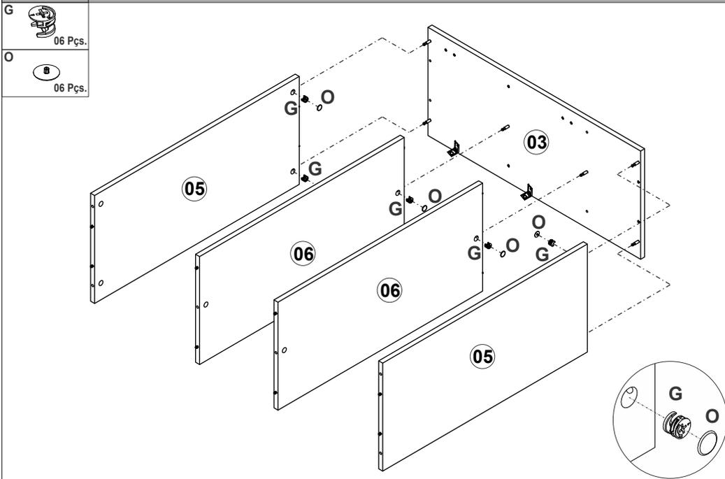
**Passo - 03 MONTAGEM** Montar o armário conforme a ilustração abaixo, unir as peças 05 e 06 na peça 04, utilizando a ferragem G e O.
