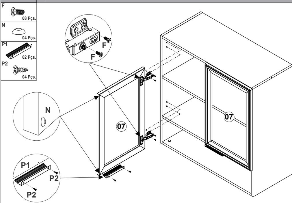
**Passo - 07 MONTAGEM** Efetuar a regulagem na porta conforme a ilustração abaixo.
