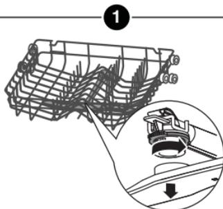
Para remover o braço de pulverização superior, mantenha a porca no centro imóvel e gire o braço de pulverização no sentido anti-horário para removê-lo.
