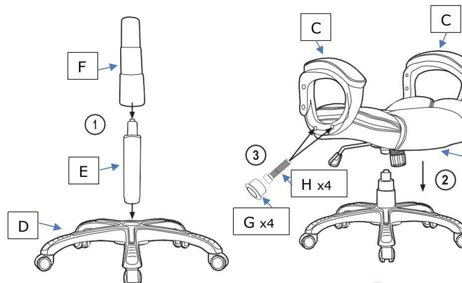
1 Encaixe o pistão (E) na base (D) e envolva-o com a capa telescópica (F).
