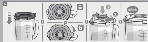
5. Coloque a jarra (C) com o conjunto de lâmina (D) fixo, na base do liquidificador (E) com a alça para a direita. Trave a jarra girando no sentido horário. Ou, alinhe a seta (▲) visto no conjunto de lâmina, com o símbolo (◻) da base.
