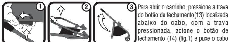
Para abrir o carrinho, pressione a trava do botão de fechamento (13) localizada abaixo do cabo, com a trava pressionada, acione o botão de fechamento (14) (fig.1) e puxe o cabo para cima, abrindo a estrutura, até ouvir um "click" que indica que a estrutura está travada (fig.2 e 3).
