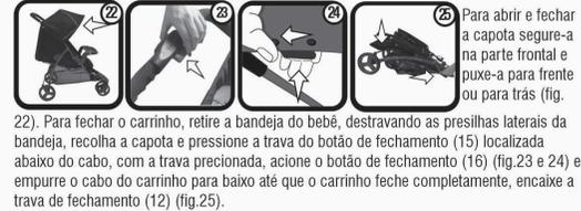
Para abrir e fechar a capota segure-a na parte frontal e puxe-a para frente ou para trás (fig. 22). Para fechar o carrinho, retire a bandeja do bebê, destravando as presilhas laterais da bandeja, recolha a capota e pressione a trava do botão de fechamento (15) localizada abaixo do cabo, com a trava precionada, acione o botão de fechamento (16) (fig.23 e 24) e empurre o cabo do carrinho para baixo até que o carrinho feche completamente, encaixe a trava de fechamento (12) (fig.25).
