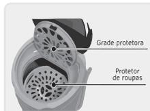
Abra a tampa do aparelho, em seguida levante a grade protetora.
