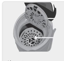
Abra a tampa transparente, levante a grade protetora, remova o protetor de roupas e retire as roupas.
