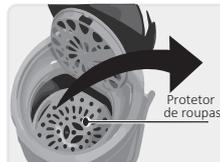
Retire o protetor de roupas e coloque as roupas uma a uma, distribuindo-as uniformemente dentro do cesto.
