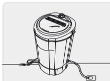
Com o plugue desconectado da tomada elétrica, posicione o aparelho sobre uma superfície plana e horizontal e coloque a mangueira de saída de água sobre um ralo.
