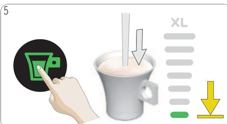
5 Toque o ícone liga/desliga. Começa o preparo da bebida. **Não abra a alavanca de fechamento durante a extração.** Aguarde até que a extração pare. A máquina para a preparação automaticamente. A extração pode ser parada manualmente a qualquer momento apertando-se o ícone liga/desliga.
