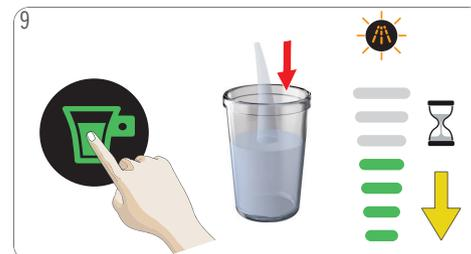
Toque o ícone liga/desliga. A máquina enxagua continuamente com água quente. O display de luzes se apaga gradativamente. A máquina para o enxágue assim que o reservatório de água estiver vazio.
