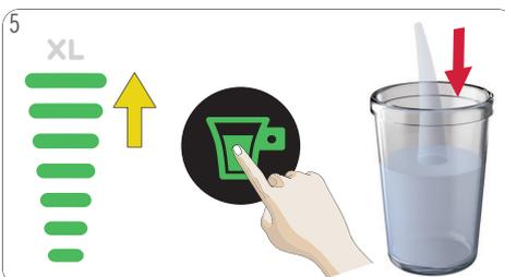
Regule o display de luz no nível máximo através do seletor de volume. Toque o ícone liga/desliga. A máquina inicia a lavagem.
