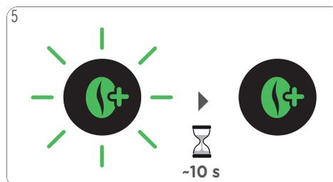
5 Pré-umedecimento: A preparação pausa e o ícone ESPRESSO BOOST começa a piscar. Após aprox. 10 segundos, a preparação continua e o botão ESPRESSO BOOST fica verde. Aguarde até que a máquina pare automaticamente. A extração pode ser parada manualmente a qualquer momento apertando-se o ícone liga/desliga.
