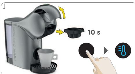
1 Abra a alavanca de fechamento. A máquina liga automaticamente. Toque o ícone de seleção da temperatura em até 10 segundos após ligar a máquina para mudar para o modo frio (azul). Bebida fria pode ser preparada imediatamente.
