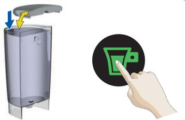
Verifique se há água potável fresca suficiente no reservatório. Em caso negativo, torne a encher com água potável fresca e toque o ícone liga/desliga para continuar com a preparação. Caso o líquido continue não saindo, verifique 10.3 “NÃO SAI LÍQUIDO – CÁPSULA BLOQUEADA?”.
