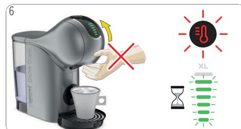
6 Após finalizar a preparação, o ícone de seleção da temperatura e o display de barras piscam por até 8 segundos. **Durante este período não abra a alavanca de fechamento!**
