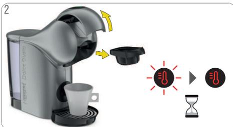
2 Abra a alavanca de fechamento. A máquina liga automaticamente. Enquanto a máquina está aquecendo, o ícone de seleção da temperatura pisca por aproximadamente 40 segundos. Em seguida, o ícone de seleção da temperatura acende com luz vermelha. A máquina está pronta para o uso.
