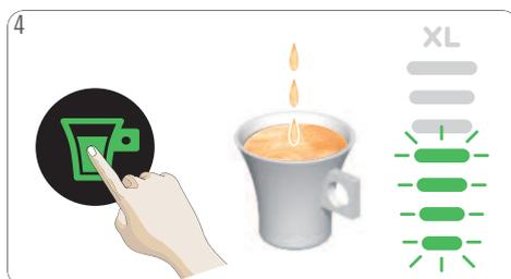
Toque o ícone liga/desliga. Começa o preparo da bebida. **Não abra a alavanca de fechamento durante a extração.** Aguarde até que a extração pare. A máquina para a preparação automaticamente. A extração pode ser parada manualmente a qualquer momento apertando-se o ícone liga/desliga.
