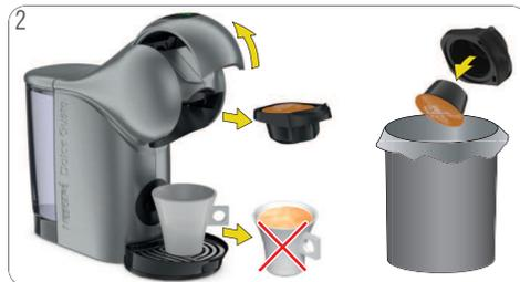
**2** Não beba o café! Abra a alavanca de fechamento. A máquina libera pressão. Remova o suporte de cápsulas. Coloque a cápsula usada no depósito de cápsulas utilizadas ou diretamente no lixo.
