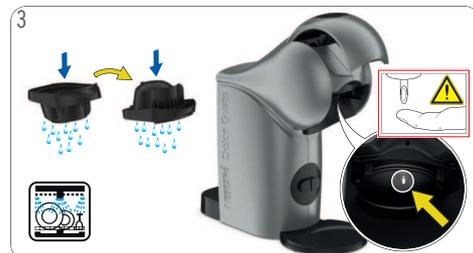
Limpe com detergente líquido e água potável fresca ambos os lados do suporte de cápsulas. Alternativamente pode ser lavado na lava-louças. Seque em seguida. Limpe a cabeça da máquina em torno do injetor com um pano macio e úmido.
