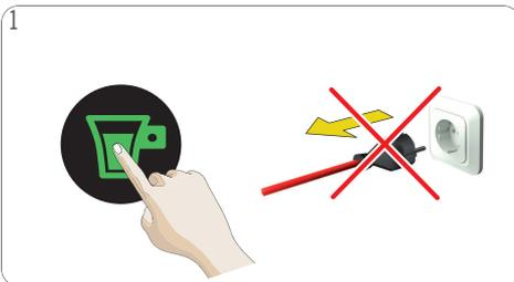
**1** **Sempre mantenha a máquina em pé!** Para parar a preparação, toque no ícone liga/desliga novamente. Não tire o cabo de força da tomada!
