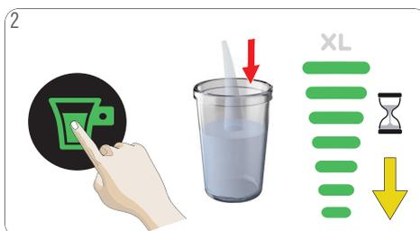
2 Para acelerar o resfriamento, selecione o nível 7 no display de barras. Toque o ícone liga/desliga. A máquina inicia a lavagem. O display de luzes se apaga gradativamente.
