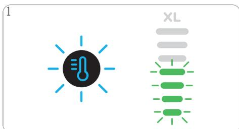
1 **Opção C:** Foi preparada uma bebida quente ou o modo frio não foi selecionado em até 10 segundos após ligar a máquina. Toque o ícone de seleção da temperatura para entrar no modo frio. O ícone de seleção da temperatura pisca azul para indicar que a máquina precisa esfriar.
