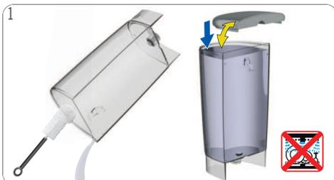
Lave e limpe o reservatório de água. Utilize uma escova limpa e detergente se necessário. Em seguida, encha o reservatório com água potável fresca e coloque-o na máquina. O reservatório de água não deve ser lavado na lava-louças!
