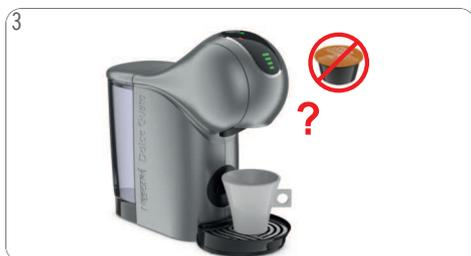
**3** Tente operar a máquina sem cápsula. Se a água fluir, fica claro que a cápsula tinha uma falha. Basta que use outra cápsula. Em caso negativo, prossiga com 10.4 “NÃO SAI LÍQUIDO – INJETOR BLOQUEADO?”.
