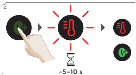
2 Pressione o ícone ESPRESSO BOOST para alterar para ESPRESSO BOOST. Enquanto a máquina está aquecendo, o ícone de seleção da temperatura pisca por aproximadamente 5–10 segundos. Em seguida, o ícone de seleção da temperatura acende com luz vermelha. A máquina está pronta para o uso.
