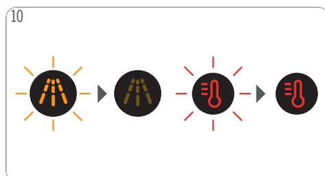
O indicador da descalcificação desliga, a seleção da temperatura pisca e acende com luz vermelha assim que a máquina estiver pronta para o uso.
