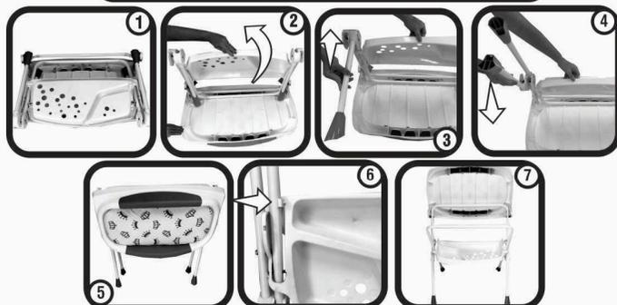
Retire a estrutura da caixa e coloque-a virada para baixo (fig.1), com o porta objetos levemente levantado (fig.2), desdobre totalmente as pernas internas e externas até ouvir um 'click', indicando o travamento (fig.3 e 4).
