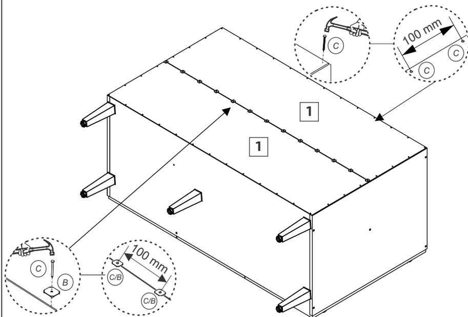
Montar o conjunto tampo conforme a ilustração abaixo, unir a peça 08 na 09 utilizando a ferragem L
