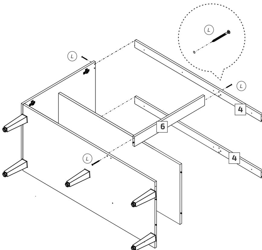
Montar o balcão conforme a ilustração abaixo, unir a peça 02 no balcão utilizando a ferragem L, fixe a cantoneira (N) na parte de baixo da prateleira e pontalete
