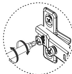
Fazer a união dos módulos conforme a ilustração abaixo, utilizar a ferragem J1 e J2.
