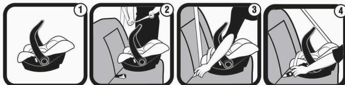
Para instalar o dispositivo de retenção no automóvel, remova a capota, conforme descrito no item 6. Posicione o dispositivo de retenção sobre o banco traseiro (fig.2). Passe o cinto de segurança primeiro pela frente do assento do dispositivo de retenção; passe a faixa abdominal do cinto de segurança do veículo, nas aberturas laterais (fig.3).
