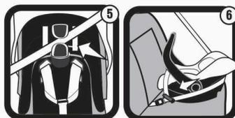
Em seguida abrace o encosto do dispositivo de retenção com a faixa torácica do cinto de segurança posicionando-o por baixo do encaixe da alça (fig.4 e 5).
