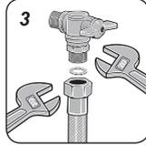
3. Encaixe o anel de vedação na outra extremidade e fixe o tubo flexível metálico no registro de parede com rosca externa  $\frac{1}{2}$ ", usando duas chaves ajustáveis.
