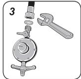
3. Encaixe o anel de vedação dentro da outra extremidade e fixe o tubo flexível metálico no regulador de pressão com registro de rosca externa  $\frac{1}{2}$ ", usando a chave ajustável.
