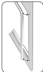
Caso necessite montar e/ou desmontar a gaxeta do forno será necessário observar o perfeito posicionamento dos ganchos.
