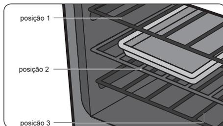
Posicione a prateleira do forno na posição 2 e faça o pré-aquecimento, conforme informado em **Instruções para Cocção no Forno**. Após o pré-aquecimento, posicione a assadeira com o alimento no centro da prateleira, conforme figura. Recomenda-se a utilização de assadeiras de alumínio.
