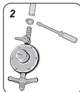
2. Coloque a outra abraçadeira na extremidade oposta da mangueira, em seguida, encaixe a mangueira no regulador de pressão e aperte a abraçadeira com a chave de fenda.
