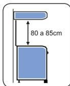
Respeite a altura de 80 a 85cm entre o fogão e um móvel, um depurador de ar ou uma coifa instalada acima do produto.
