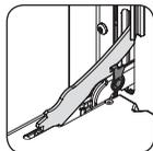
Abra totalmente a porta do forno, levante a presilha da dobradiça da porta conforme indicado nas figuras ao lado.
