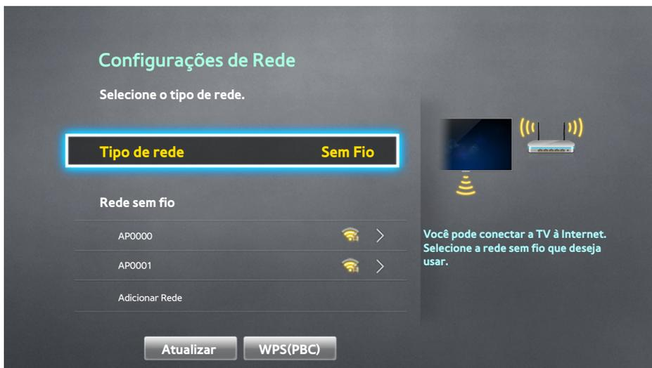
2. Selecione uma rede (SSID). Se a rede desejada não for exibida na lista, selecione **Adicionar Rede** e digite o SSID da rede manualmente.
