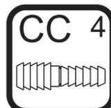
1 - Encaixe as cavilhas escalonadas CC (8x26mm) no topo das laterais 1 conforme desenho
